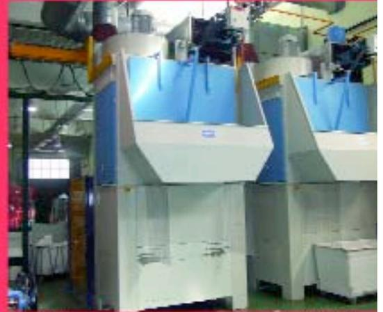
Túnel de lavado de ropa con capacidad para 800 kg/hora
