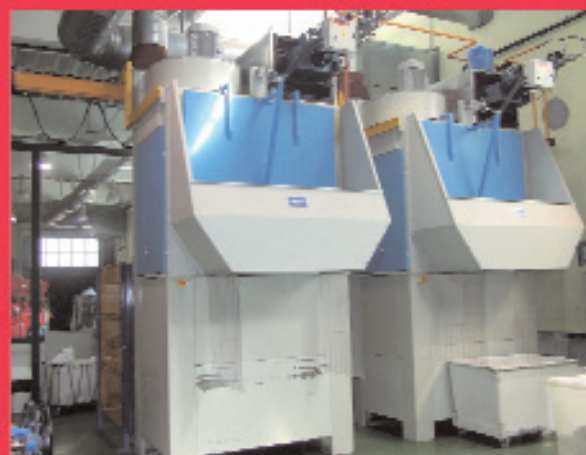
Túnel de lavado de ropa con capacidad para 800 kg/hora
