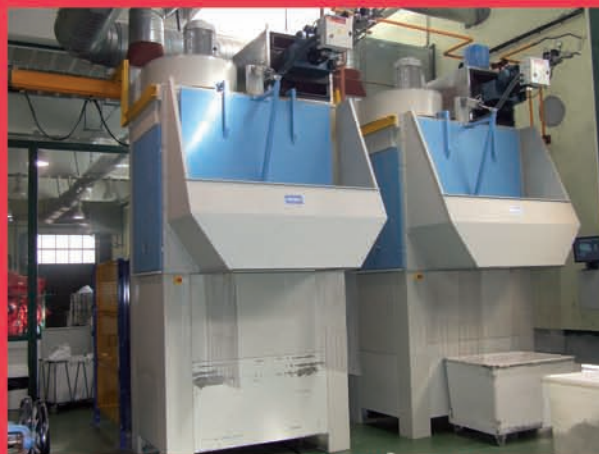
Tunel de lavado de ropa con capacidad para 800 kg/hora
