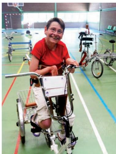
como son: ampliar estabilidad, anclajes para sujeción, un piñón fijo, manillar en ‘u’, una polea para los pedales, bloques de separación en las piernas, etc.
